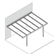
B2 bündig, Pfosten eingerückt
