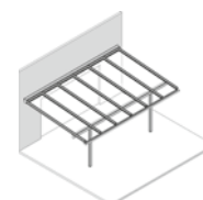
Ü2 Sparrenüberstand, Pfosten eingerückt
