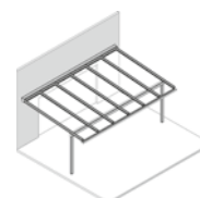
Ü1 Sparrenüberstand, Pfosten außen
